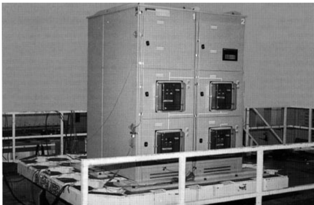
Fig. 28: Armario BT para una central nuclear durante las pruebas de ensayo de calificación.
